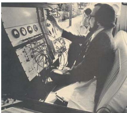
Fot. 1. Pierwszy georadar montowany na Vanie do pomiarów drogowych, inicjatywa amerykańskiej firmy GSSI [20]
