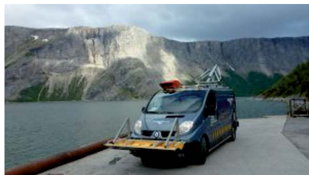
Fot. 2. Georadar wieloantennyowy o częstotliwości krokowej – „3D” [19]
