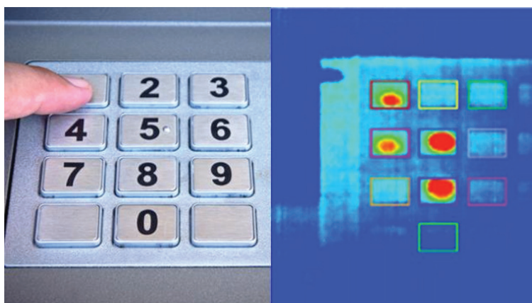
Rys. 1. Analiza kanału bocznego wykorzystująca temperaturę oraz podatność konstrukcji (przyciski z metalu, które dobrze przewodzą ciepło) do pozyskania wpisywanego przez użytkownika kodu PIN [3]
