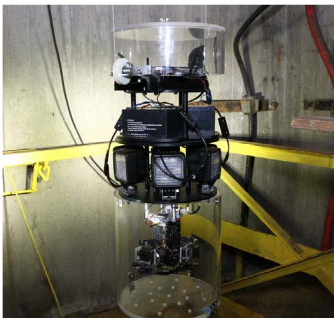
Fot. 2. Zestaw monitoringu wizyjnego Fot 2. Video monitoring set
