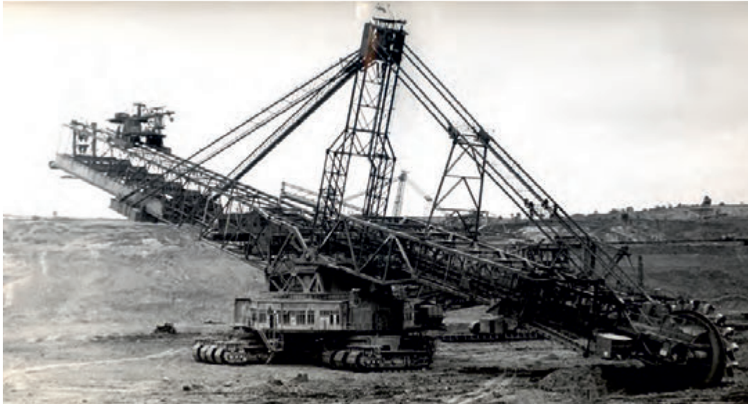
Rys. 1. Koparka SRs 2400 podczas badań, urabiająca podpoziomowo nadkład w Kopalni Machów Fig. 1. BWE SRs 2400 during testing, mining working to the deep in open pit mine Machów
