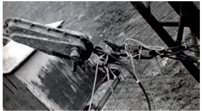
Rys. 4. Uchwyt ze zrywaną próbką i ręcznym wciąganiem linowym Fig. 4. Mount handle the tear a sample and manual hoist rope
