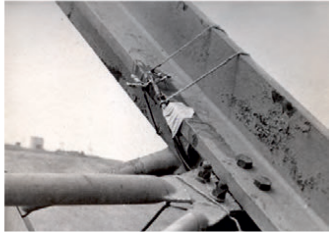
Rys. 2. Przykładowe tensometryczne punkty układów pomiarowych na wysięgniku koła i cięgnach koparki SRs 2400 Fig. 2. Strain gauge measurement points of stress on the boom bucket wheel and tendon BWE SRs 2400
