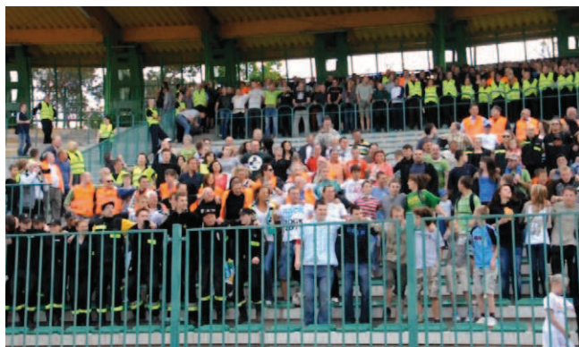
Rys. 3. Testy dynamiczne z udziałem kibiców (najniekorzystniejsze ustawienie, kibice tańczą „Labado” na dolnej i najwyższej, wspornikowej części trybuny)
