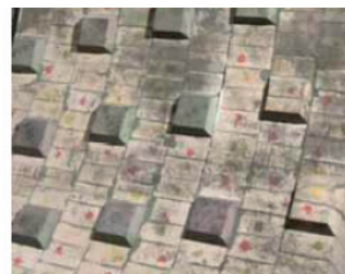
Ryc. 2. Gardziel pieca obrotowego z wyprofilowanymi elementami obmurza
