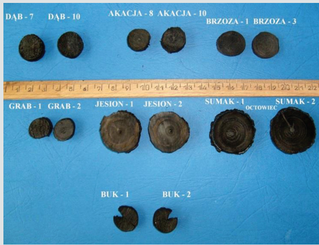
Rys. 4. Przykładowe próbki drewna po procesie pirolizy
