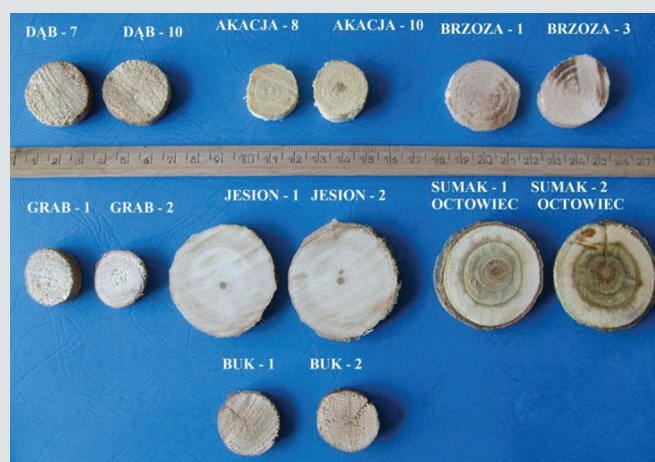
Rys. 3. Przykładowe próbki drewna przed procesem pirolizy
