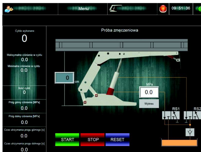
Rys. 10. Ekran próby zmęczeniowej sekcji obudowy zmechanizowanej [3]
