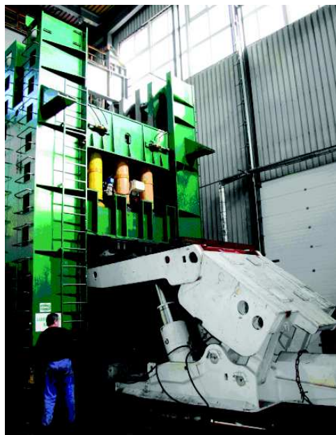
Rys. 1. Stanowisko do badań wytrzymałości sekcji obudowy zmechanizowanej [1]
