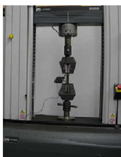
Rys. 5. Widok próby rozciągania skorodowanej rury
