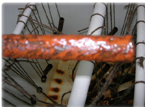
Rys. 4. Widok skorodowanej rury w komorze mgły solnej
