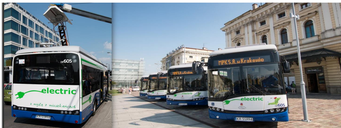
Rys. 9. Widok ogólny autobusów z napędem elektrycznym Solaris Urbino 12 Electric (po lewej – podczas ładowania zasobników energii na ul. Pawiej) i (po prawej – przed budynkiem Dworca Głównego w Krakowie)
