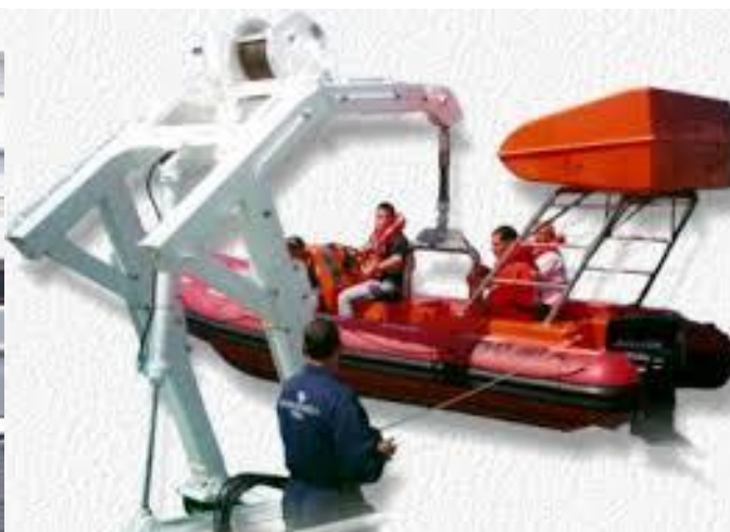
Rys. 6.. Widoki przykładowe żurawie z napędem hydrauliczny na pokładzie jachtu morskiego
