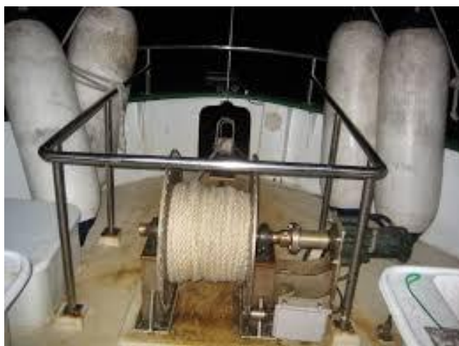
Rys. 4.. Widoki na napęd hydrauliczny wciągarki na pokładzie jachtu morskiego Źródło: Wilmex catalogue [4]
