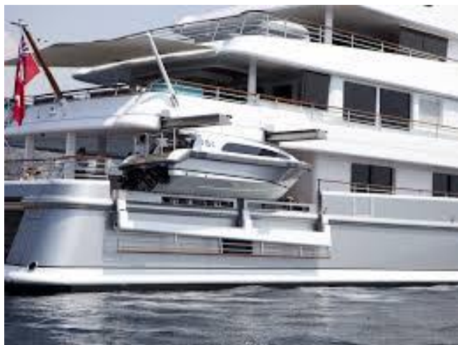
Rys. 6.. Widoki przykładowe żurawie z napędem hydrauliczny na pokładzie jachtu morskiego
