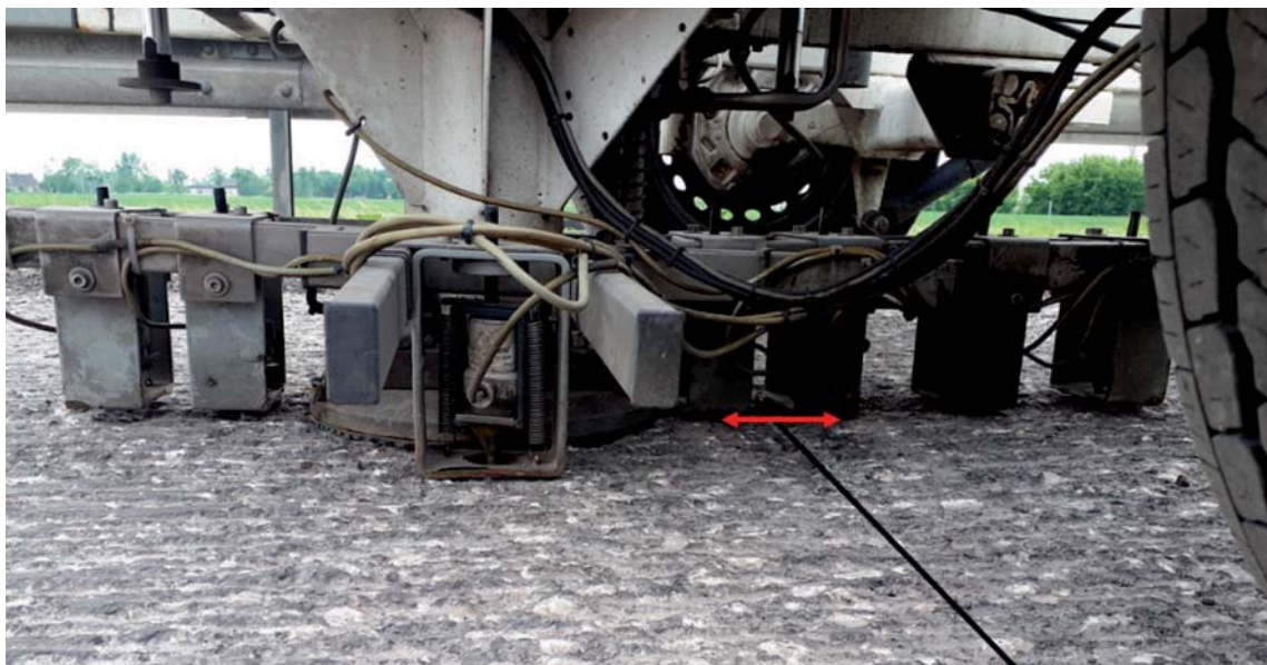
Fot. 1. Praktyczna realizacja pomiaru LTE (fot. TPA)
