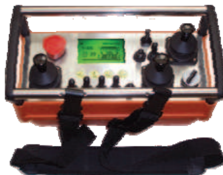
Fot. 17. Pulpit radiowego sterowania typu RSO-CH [1]
