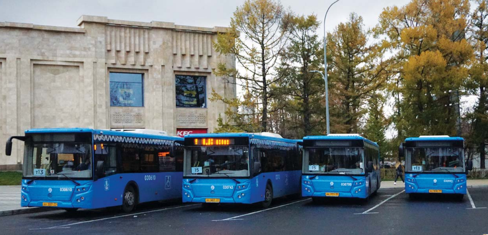
Trzon floty autobusowej Mosgotransu stanowią autobusy LiAZ 5292 i 6213 ze zmodernizowaną ścianą przednią i tylną
