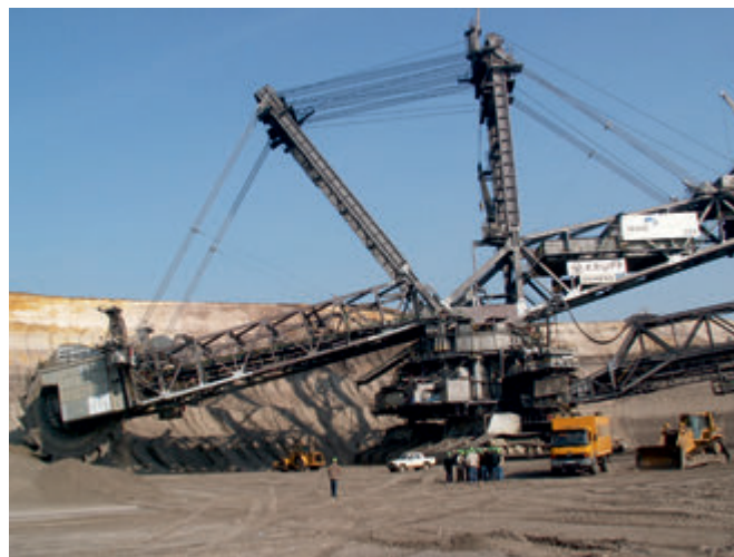
Rys. 3 Koparka SchRs 6600 w kopalni Garzweiler Fig. 3. Excavator SchRs 6600 in Garzweiler mine
