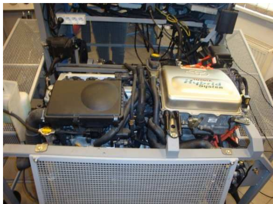
Rys. 3. Stanowisko hamowniane: silnik spalinowy wraz z układem hybrydowym, b) koła retardera (obciążenie układu napędowego)
