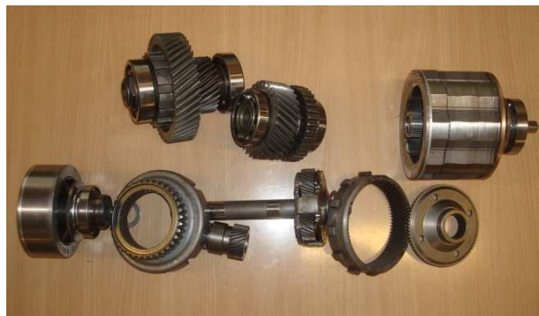
Rys. 3. Przekładnia napędu hybrydowego: a) obudowa i stojany silników elektrycznych, b) elementy mechaniczne przekładni napędu hybrydowego
