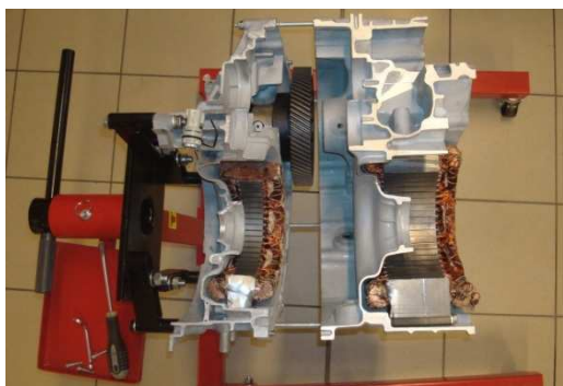
Rys. 3. Przekładnia napędu hybrydowego: a) obudowa i stojany silników elektrycznych, b) elementy mechaniczne przekładni napędu hybrydowego
