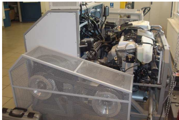
Rys. 3. Stanowisko hamowniane: silnik spalinowy wraz z układem hybrydowym, b) koła retardera (obciążenie układu napędowego)
