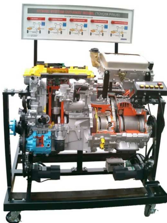
Rys. 1. Przekroje napędu hybrydowego: a) stanowisko w Laboratorium Silników Spalinowych Politechniki Poznańskiej – demontowalne, b) przykład modelu – niedemontowalny [4], c) stanowisko wykonane przez Technolab SA (Szwajcaria) [3], d) stanowisko wykonane przez NADA Scientific LTD (USA) [5]
