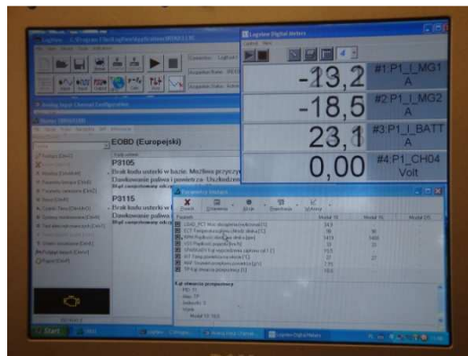
Rys. 4. Stanowisko badawcze: a) miejsce zamontowania cęg prądowych, b) widok ekranu akwizycji danych pomiarowych (zaciski amperomierza na przewodach elektrycznych: 1 – silnika elektrycznego/generatora, 2 – silnika elektrycznego, 3 – baterii akumulatora)
