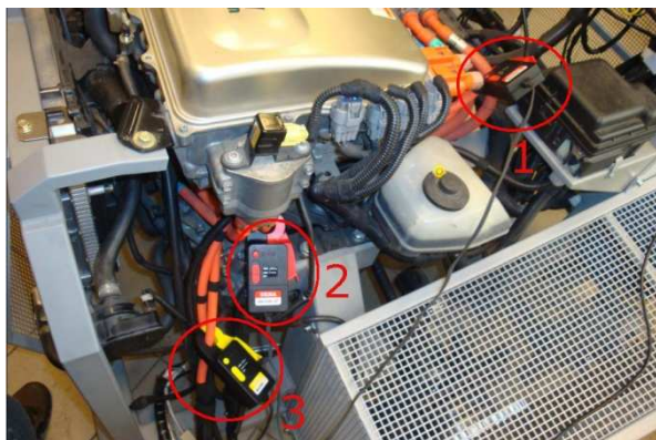
Rys. 4. Stanowisko badawcze: a) miejsce zamontowania cęg prądowych, b) widok ekranu akwizycji danych pomiarowych (zaciski amperomierza na przewodach elektrycznych: 1 – silnika elektrycznego/generatora, 2 – silnika elektrycznego, 3 – baterii akumulatora)
