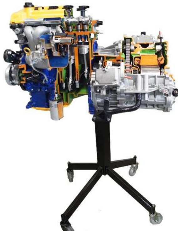
Rys. 1. Przekroje napędu hybrydowego: a) stanowisko w Laboratorium Silników Spalinowych Politechniki Poznańskiej – demontowalne, b) przykład modelu – niedemontowalny [4], c) stanowisko wykonane przez Technolab SA (Szwajcaria) [3], d) stanowisko wykonane przez NADA Scientific LTD (USA) [5]
