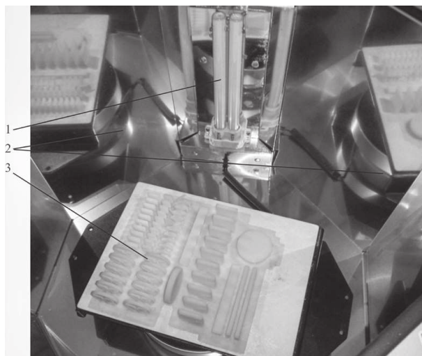
Rys. 5. Wygląd wnętrza komory do naświetlania UV: 1 – żarówka UV, 2 – odbijające światło powierzchnie boczne komory, 3 – platforma robocza z wytworzonymi elementami
