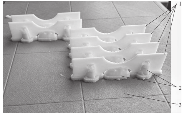
Rys. 2. Wygląd elementów wytworzonych metodą FDM: 1 – wytworzony element, 2 – warstwa podporowa i podpory, 3 – platforma robocza
