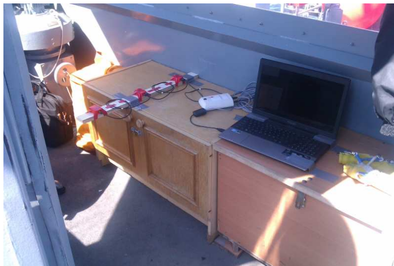
Rys. 2. System pomiaru parametrów ruchu okrętu na pokładzie ORP Czajka
