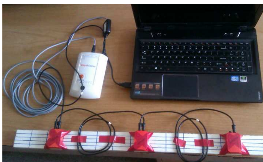
Rys. 1. System pomiaru parametrów ruchu okrętu bazujący na INS
