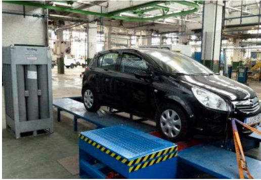
Rys. 1. Pojazd z silnikiem badawczym wyposażonym w instalację wodorowego zasilania na stanowisku hamowni podwoziowej
