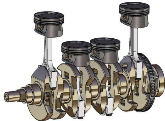
Rys. 3. Model CAD układu korbowo-tłokowego silnika badawczego A14XER
