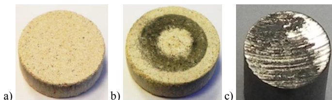
Rys. 3. Przykłady: a) przeciwpróbka, b) przeciwpróbka po badaniu, c) próbka po badaniu Fig. 3. Examples: a) counterspecimen, b) counterspecimen after the test, c) the sample after the test
