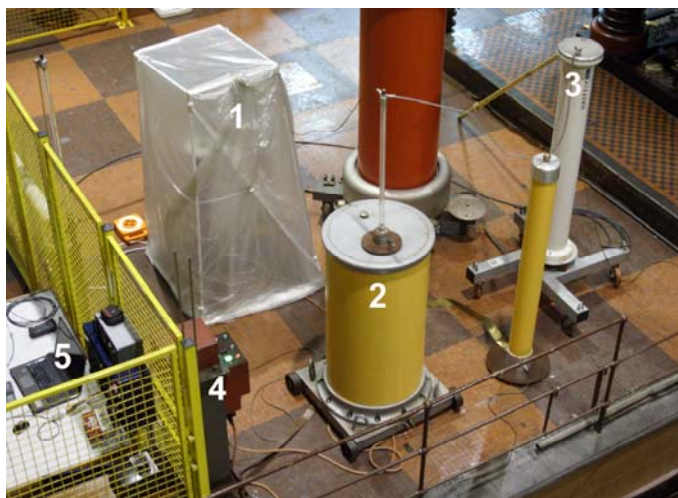
Rys. 3. Widok ogólny stanowiska pomiarowego, gdzie: 1 – komora termiczna, 2 – TP-110, 3 – RCZ500Ref, 4 – TRP-10, 5 – stanowisko regulacyjno-pomiarowe
