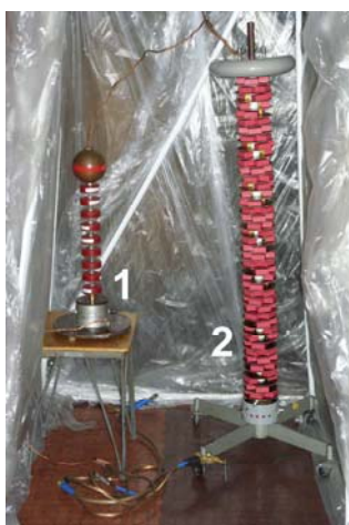
Rys. 4. Komora przed umieszczeniem elementu grzejnego Dzielnik z kondensatorami : 1 – ceramicznymi, 2 – polipropylenowymi
