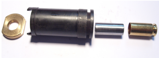
Fot. 5. Układ miotający w stanie rozłożonym. Od lewej: uszczelniacz I wariant, komora nabojowa, ogranicznik objętości ładowania i zaspłokowana łuska 9 × 19 mm Parabellum
