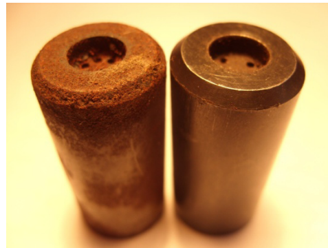
Fot. 4. Przednie powierzchnie komór nabojowych. Po lewej stara komora poddana erozji gazów prochowych
