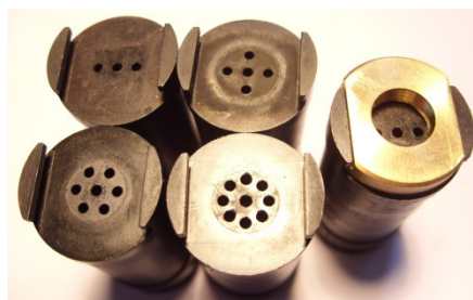
Fot. 7. Widok czoła komór z 3, 5, 7 i 9 otworami. Po prawej komora z 3 otworami i zamontowanym uszczelnieniem I typu
