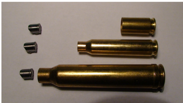
Fot. 2. Łuski stosowane do luf z różnymi komorami nabojewymi z przewodem lufy kalibru 5,56 mm. Od góry: 9 × 19 mm Parabellum, 5,56 × 45 mm NATO, 7,62 × 67B mm (.300 Winchester Magnum)
