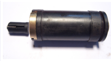
Fot. 6. Od lewej: odlamek w sabocie, scalony układ miotający
