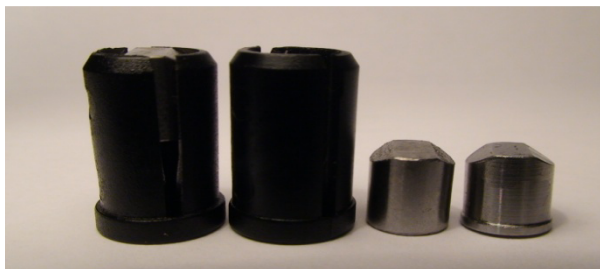
Fot. 1. Od lewej: odłamek z sabotem, sabot, odłamek do zastosowania z sabotem, odłamek (ze zgrubieniem pełniącym funkcję pierścienia wiodącego) do stosowania bez sabotu
