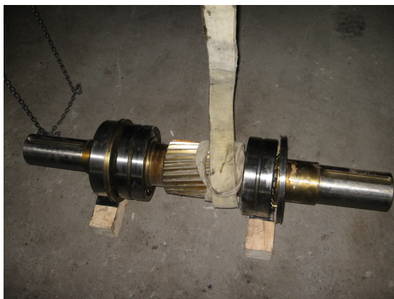
Rys. 14. Wał szybkoobrotowy przekładni napędu głównego młyna cementu z uszkodzonym łożyskiem
