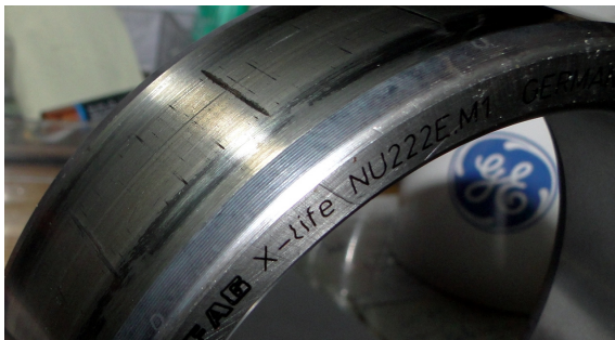
Rys. 4. Bieżnia wewnętrzna łożyska NU222E
