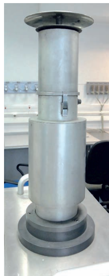
Rys. 2. Schemat głowicy poboru dla pyłu PM 10 i PM 2,5 dla przepływu 2,3 m 3 /h. Źródło: PN-EN 12341:2014. (zdjęcie: T. Frączkowski)
