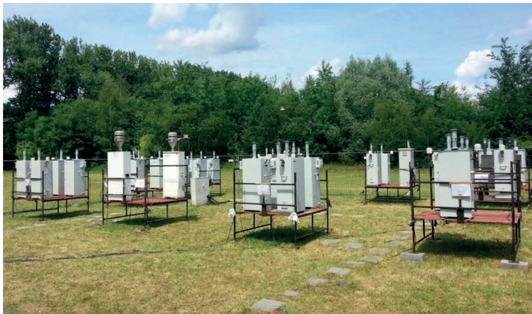
Rys. 4. Badania porównawcze dla pomiarów pyłu PM10 i PM2,5 (zdjęcie: A. Pindel)
