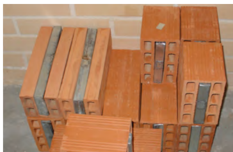
Rys. 2. Pustaki ceramiczne z wkładem z materiałów zmiennofazowych [4]
