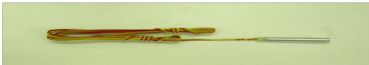
Rys. 2. Laboratoryjna elektryczna sponka pobudzająca zawierająca badany IMW
