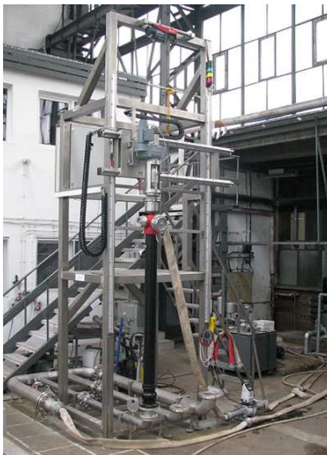
Fot. 1. Badanie trwałości hydrantu nadziemnego
