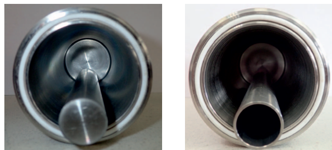
Fot. 1. Komora testowa do badań akrecji zwiercin Phot. 1. Accretion Test Cell – Solid Steel Bar
