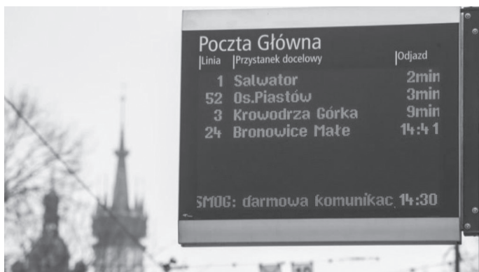
Rys. 2. Tablica zmiennej treści na przystanku tramwajowym w Krakowie
