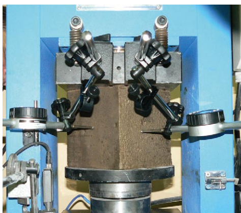
Rys. 7. Badania z kontrolą ścieżki naprężenia – próbka sześcienna
