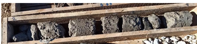
Rys. 5. Rdzeń odwiercony z gotowej kolumny (w gruncie) – widoczna mnogość spękań i ryzyko konieczności wycinania próbek „nie-normowych”
