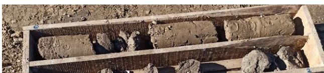
Rys. 6. Rdzeń odwiercony z gotowej kolumny (w gruncie) – nieliczne spękania
