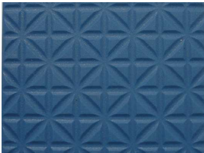
Fot. 1. Widok płytek wyprasowanych i wypalonych w Ceramice Paradyż Sp. z o.o. w Opocznie na bazie granulatu szklanego opracowanego w Sieci Badawczej Łukasiewicz Instytucie Ceramiki i Materiałów Budowlanych w Warszawie (granulat barwiony i podstawowy).
