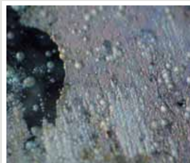
Fot. 12. Nawarstwienia korozyjne oraz widoczna delaminacja powierzchni szkła, fragment 4A, powiększenie 40x. Fot. N. Kowalczyk.
