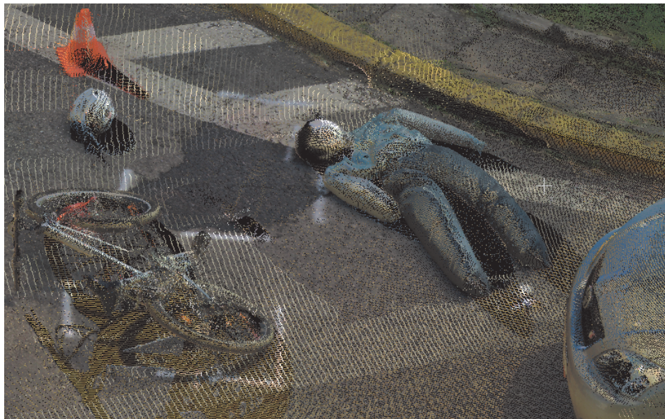
Ryc. 15. Odtworzenie pozycji ciała (manekin) za pomocą chmury punktów 3D pozyskanej za pomocą stacjonarnego skanera laserowego.
