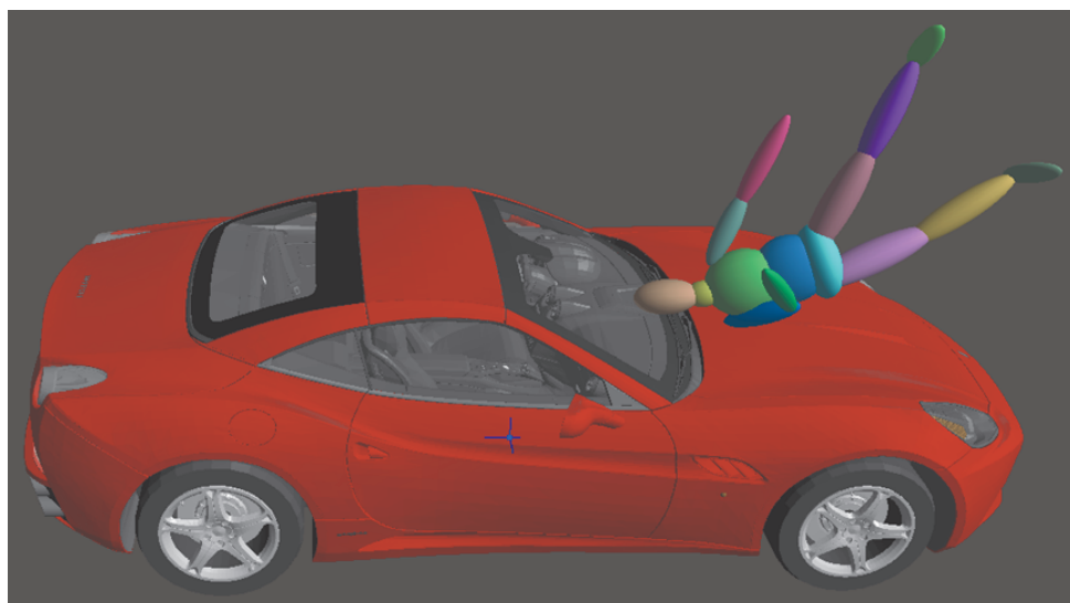
Ryc. 20. Analiza potrącenia pieszego za pomocą modelu wielobryłowego w V-SIM 5.0.
