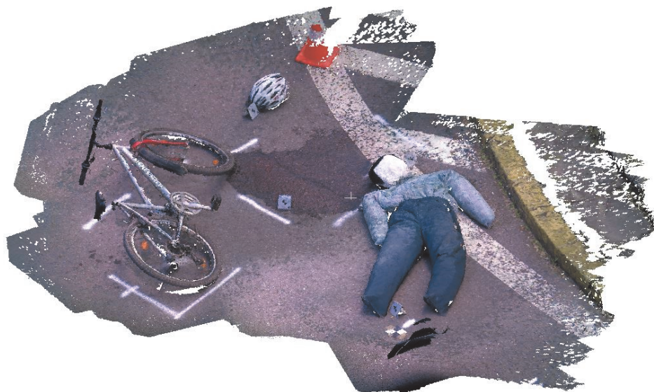
Ryc. 16. Odtworzenie pozycji ciała (manekin) za pomocą chmury punktów 3D pozyskanej za pomocą skanera ręcznego.
