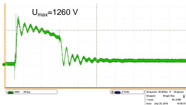
Rys. 5. Napięcie U_{LI-N} na zaciskach zasilacza impulsowego (3) dla prądu generatora 15 kA – nastawy oscyloskopu 300 V/div, 20 \mu s/div
