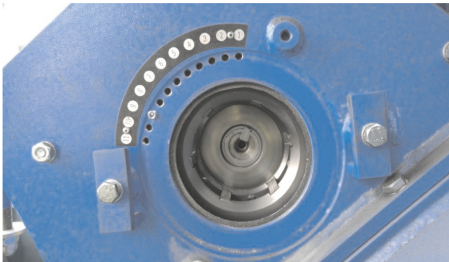
Rys. 8. System ustawiania położenia okienka tulei regulacyjnej w oczyszczarkach firmy CM [8]
