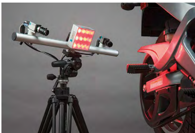
Rys. 2. Elementy systemu DIC firmy DANTEC, źródło: https://www.ita-polska.com.pl
