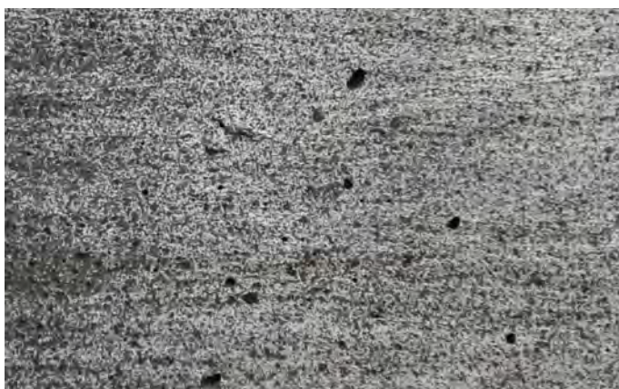
Rys. 4. Struktura plamkowa na powierzchni badanego elementu
