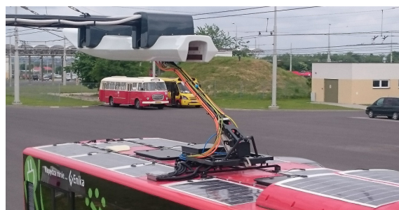
Rys. 8. Fotografia stanowiska ładowania z pantografu o prądzie maksymalnym 1000A
