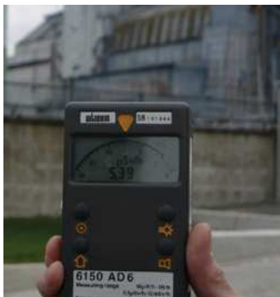
Fot.2. Przed sarkofagiem reaktora nr IV w Czarnobylu – moc dawki ok. 5-6 \mu\text{Sv/h}
