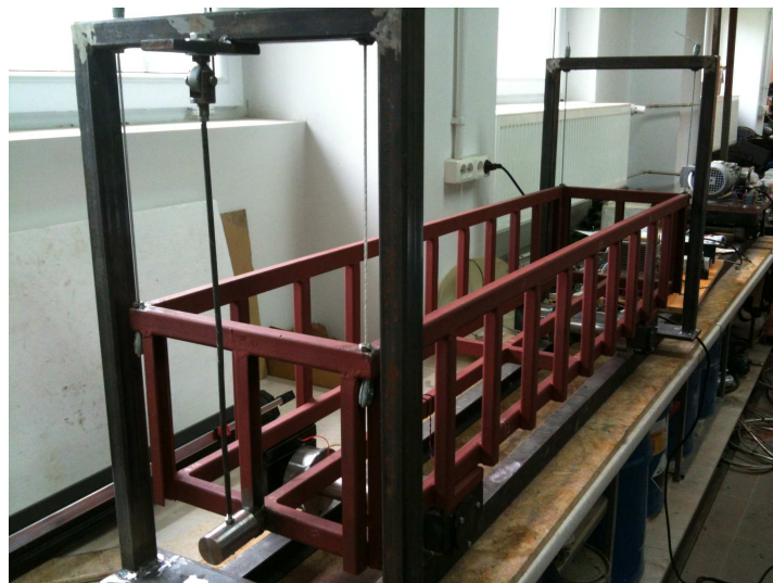
Rys. 4. Model wagonu (system półokreślony) wraz z wahadłem
