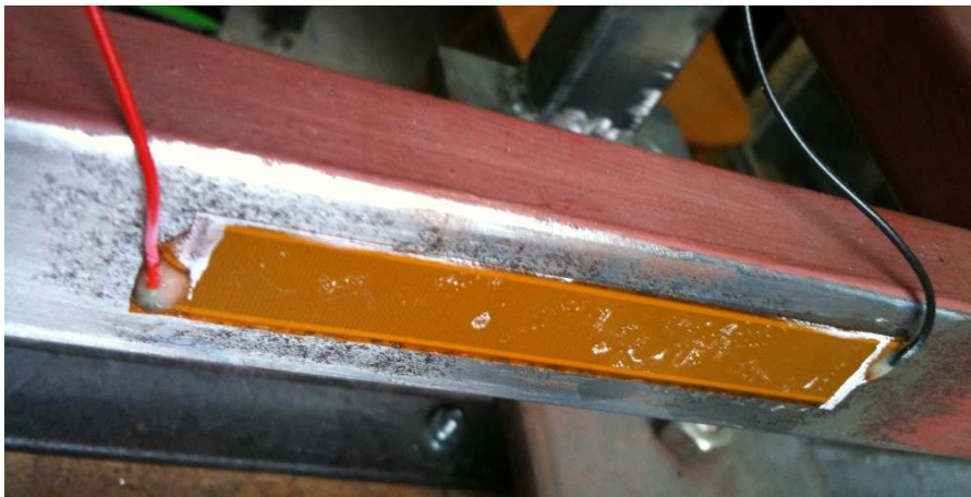
Rys. 5. Przetwornik MFC M8514-P1 naklejony na badany model
