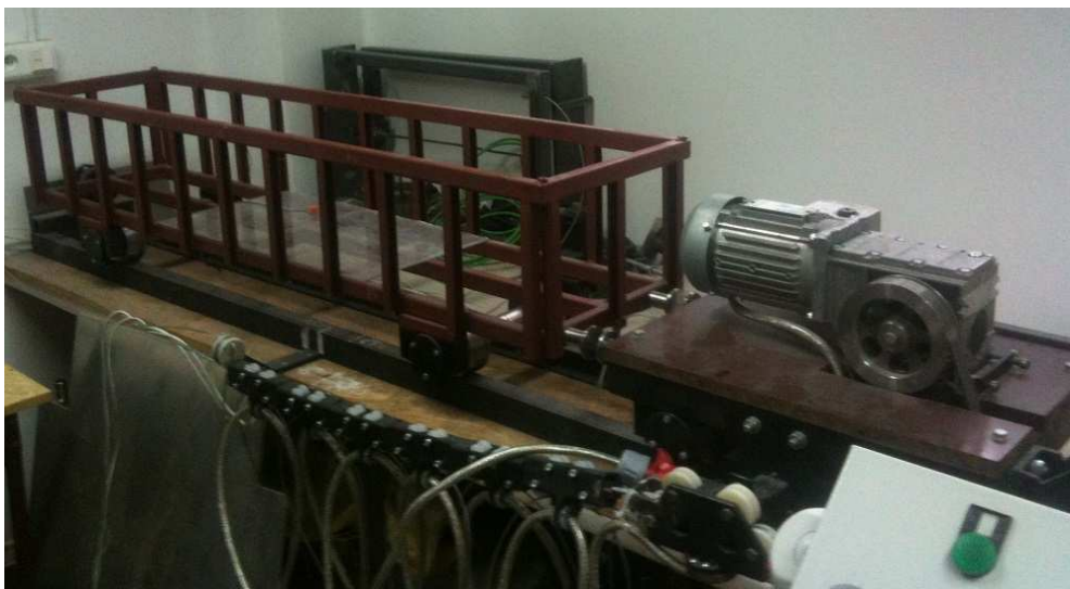
Rys. 2. Stanowisko laboratoryjne do badania odpowiedzi dynamicznej modelu wagonu towarowego
