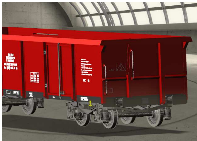
Rys. 1. Węglarka typu EAOS 1415-A3 (a) oraz jej model CAD (b)
