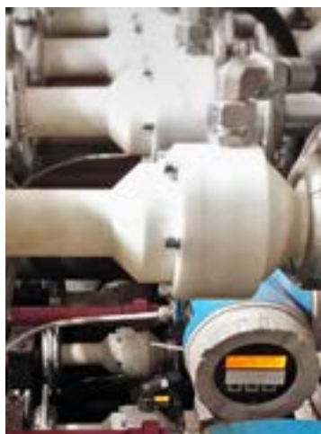
Ryc. 3. Generator piany. Schemat działania i widok urządzenia
