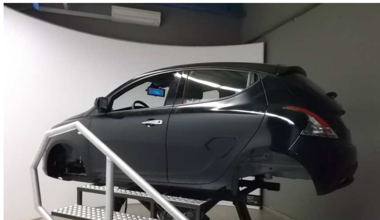
Rys. 1. Zdjęcie nadwozia samochodowego umieszczonego na hexapodzie z widocznym ekranem i wejściem dla kierowcy
