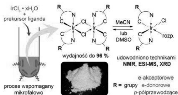
Rysunek 44. Schemat ilustrujący otrzymywanie oraz reaktywność dwurdzeniowych kompleksów Ir(III) Figure 44. Scheme illustrating the preparation and reactivity of binuclear Ir(III) complexes
