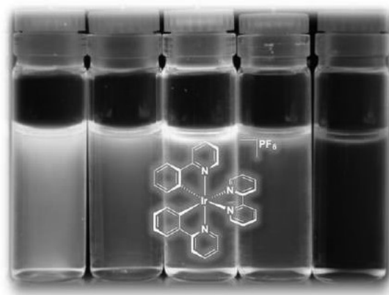
Rysunek 5. Ilustracja możliwości przestrajania emisji kompleksów irydu(III) w zależności od ich budowy [28] (Licencja na reprint nr 1090375-1)
