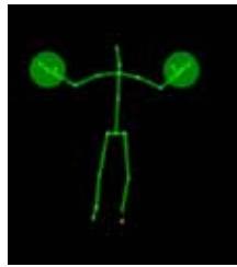
Rys. 2a Od lewej: szkielet osoby śledzonej przez czujnik Kinect v2 oraz szkielet połączony z obrazem z kamery.
