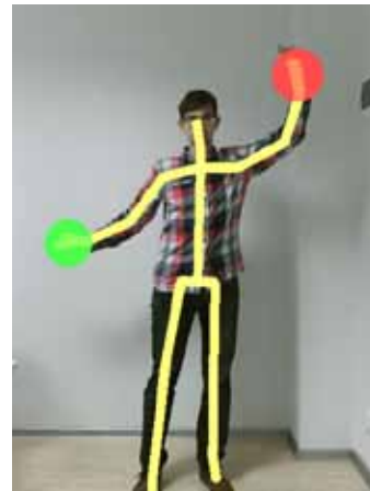
Rys. 2a Od lewej: szkielet osoby śledzonej przez czujnik Kinect v2 oraz szkielet połączony z obrazem z kamery.
