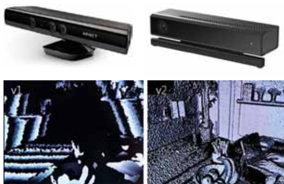
Rys. 3 U góry: Czujnik Kinect v1 [8] i v2 (Microsoft); na dole: obraz głębokości dostarczany przez czujnik Kinect v1 i v2 [9].
