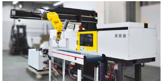
Rys. 12. FANUC Roboshot wraz z robotem LR Mate 200iD zainstalowanym na dodatkowej osi (Źródło: http://FANUCrobotics.pl )
