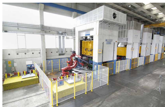
Rys. 8. Linia pras w tłoczni obsługiwana przez roboty COMAU
