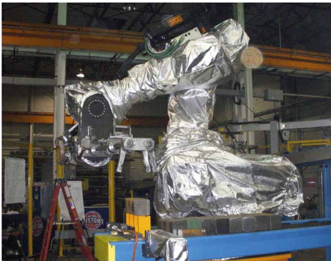
Rys. 10. Robot KUKA KR1000 przystosowany do pracy w wysokich temperaturach (Źródło: http://roboworld.com )
