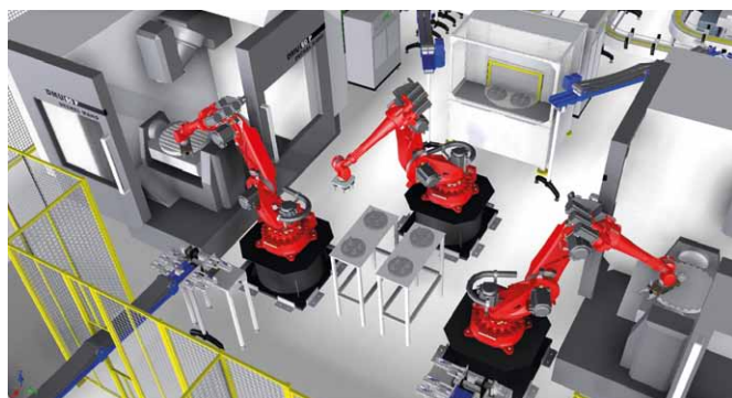
Rys. 7. Wizualizacja stanowiska obsługi maszyn przez roboty COMAU
