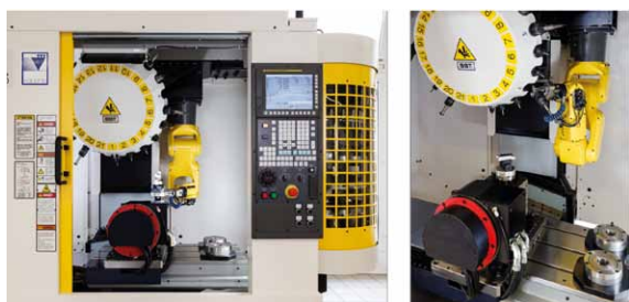
Rys. 4. Robot FANUC LrMate 200iD zainstalowany wewnątrz centrum obróbczego Robodrill (Źródło: FANUC)
