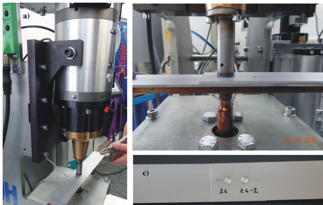
Rys. 3. Stanowisko do zgrzewania tarcowego RFSSW:
