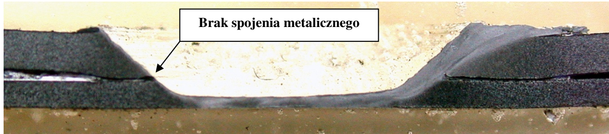
Rys. 6. Asymetria połączenia metalicznego w punktowym złączy zgrzewanym FSSW Fig. 6. Asymmetry of the metallic bond in an FSSW spot welded joint
