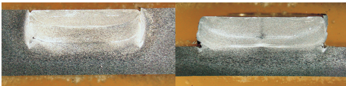
Rys. 9. Makrostruktury złącza zgrzewanego tarciowo RFSSW (parametry – rys. 3): a) złącze A7075, 2,5+2,5 mm; b) złącze po próbie ścinania
