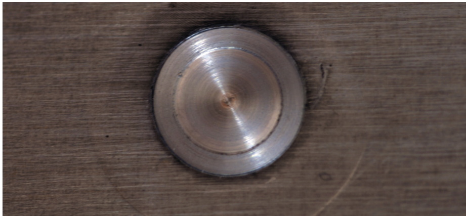
Rys. 8. Lico zgrzeiny punktowej wykonanej z zastosowaniem narzędzia z ruchomym trzpieniem. Średnica trzpienia 5,2 mm, średnica tulei zewnętrznej 9,0 mm
