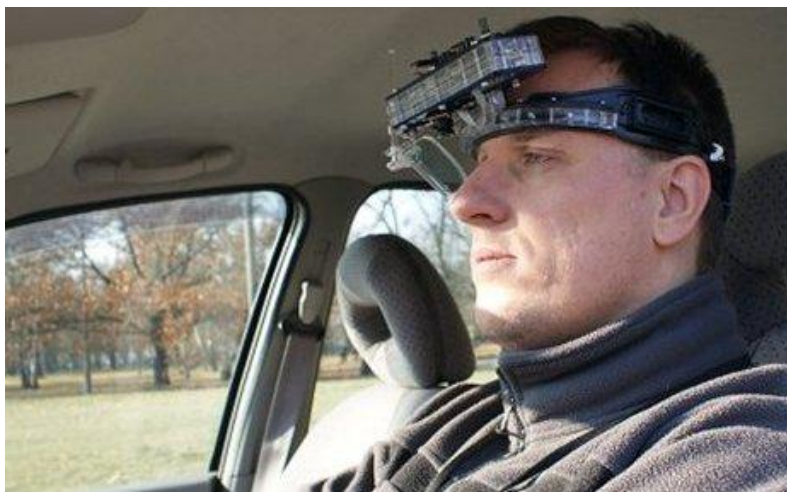
Rys. 2. Urządzenie odpowiedzialne za pozyskiwanie obrazu oka
