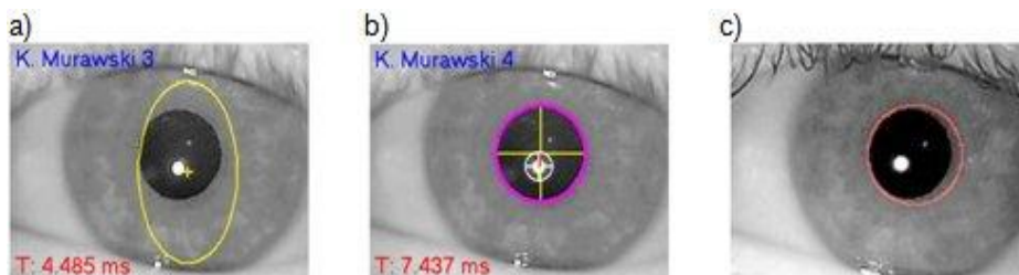
Rys. 3. a) metoda PCCM (ang. pupil centre calculation method ) bez etykietowania, b) metoda PCCM z etykietowaniem, c) operator Daugmana
