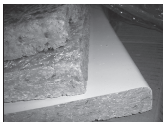
Rys. 1. Materiał budowlany z odpadami poliestrowo-szklanymi
