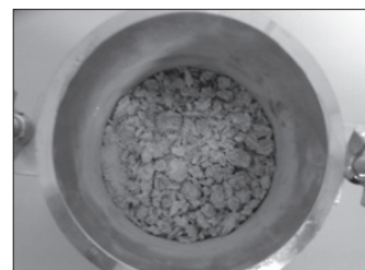
Rys. 2. Otrzymane kruszywo z recyklingu materiałów budowlanych z odpadami poliestrowo-szklanymi
