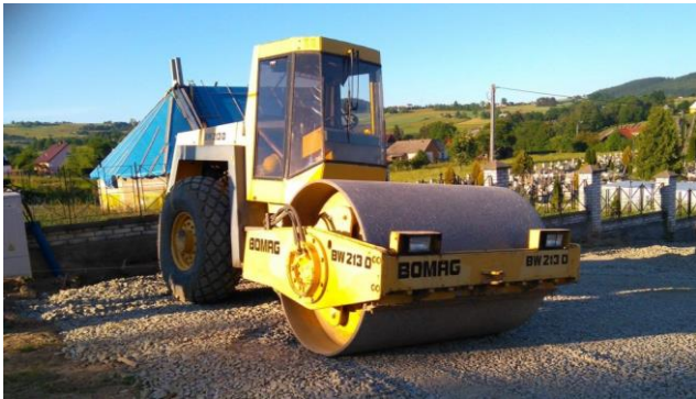
Rys. 3. Walec drogowy wibracyjny BOMAG BW 213D
