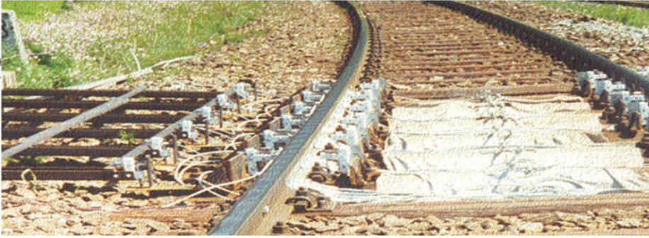
Rys. 4. Tor z układem czujników na łuku toru przed mostem w Brixental
