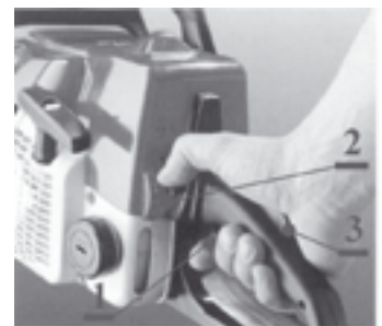
Fot. 4. Elementy sterownicze spalinowej pilarki łańcuchowej: 1 – przycisk przyspiesznika; 2 – wielopozycyjna dźwignia do zimnego uruchamiania oraz do wyłączania zapłonu pilarki; 3 – blokada przycisku przyspiesznika
